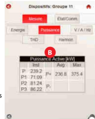
Toucher sur les deux flèches dans la partie basse de la page pour afficher les différents tableaux pour la grandeur électrique sélectionnée (ex. pour l'Énergie: énergie Active, Réactive et Apparente).
