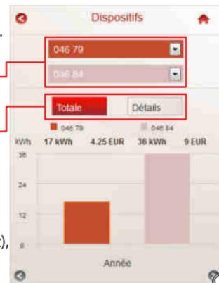
**Note :** En sélectionnant deux Dispositifs / Zones / Circuits non homogènes (ex. Électricité et Gaz), la comparaison est évaluée seulement en fonction de la devise (EUR ou autre devise) et non en fonction des unités de mesure. Il n'est pas possible de comparer "Wh d'électricité et "Wh équivalents" de gaz.
