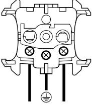
Розетки поставляются с разомкнутыми зажимами и ослабленными винтами.
