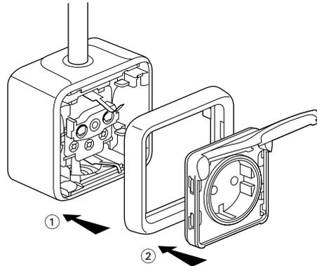
Крепление верхней части к монтажной коробке, обеспечивающее степень защиты розетки IP55, выполняется поворотом отвертки на 1/4 оборота.
