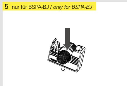
Bei Bedarf Schraube für zentrale Befestigung setzen, Wellrohr zusammen mit den montierten Halbschalen in den Systemhalter einführen. Weiter mit Bild Nr. 2.
