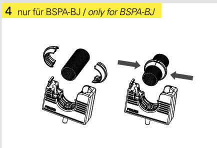
Bei Verwendung der Kugelgelenk-Variante BSPA-BJ, beide Kugel-Halbschalen auf gewünschte Position um das Wellrohr legen und bis zum „click“ zusammenstoßen.
