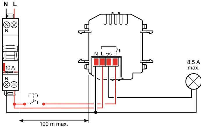
Un appui sur la commande auxiliaire permet d'allumer ou d'éteindre manuellement la charge. Si aucune action n'est effectuée sur la commande, le détecteur coupera sa charge en fin de temporisation ou lorsque le seuil de luminosité sera atteint.
