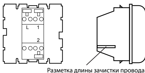
Разметка длины зачистки провода
