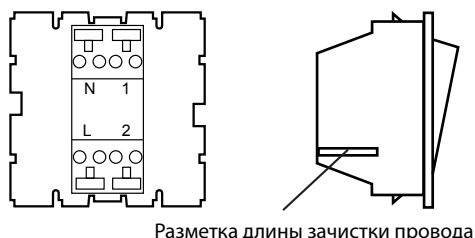
Разметка длины зачистки провода
