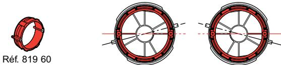
Le couvercle réf.819 71 permet l'association des boîtes 819 40 ou 819 41 en configuration côte à côte. De cette façon, il sera possible de positionner dea appareillages monoposte côte à côte.
