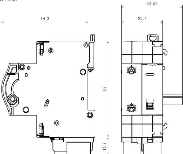
Изделие с удлинённым рычагом подсоединяется к аппарату шириной два модуля и более (BA 2P, 3P, 3P+N, 4P, АВДТ, ВДТ, 69,85)
