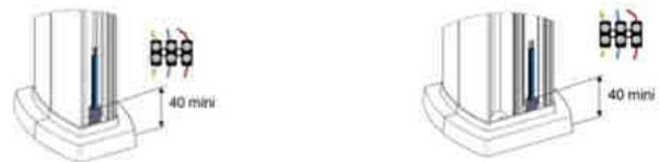
L'arrivée des câbles peut être réalisée par le sol, via faux plancher/passage de plancher, ou par le plafond avec les kits d'extension Ovaline kits références 6 530 63/65.
