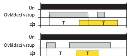
Po přivedení napájecího napětí je relé rozepnuto. Je-li sepnut ovládací kontakt, začne časové zpoždění T. Po ukončení časování relé sepne. Rozpojením ovládacího kontaktu začne nové časové zpoždění T. Po ukončení časování relé rozepne. Je-li ovládací kontakt rozpojen během časování, po ukončení časování relé sepne a po uplynutí nového časového zpoždění T relé rozepne. Další změna stavu ovládacího kontaktu v průběhu časování je ignorována.
