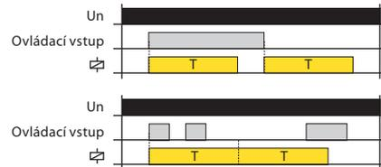
Po přivedení napájecího napětí je relé rozepnuto. Je-li sepnut ovládací kontakt, relé sepne a začíná časové zpoždění T. Po ukončení časování relé rozepne. Rozpojením ovládacího kontaktu relé znovu sepne a začíná časové zpoždění T. Po ukončení časování relé rozepne. Je-li ovládací kontakt rozpojen během časování, relé zůstane sepnuto po dobu 2T. Po ukončení časování relé rozepne. Další změna stavu ovládacího kontaktu v průběhu časování je ignorována.
