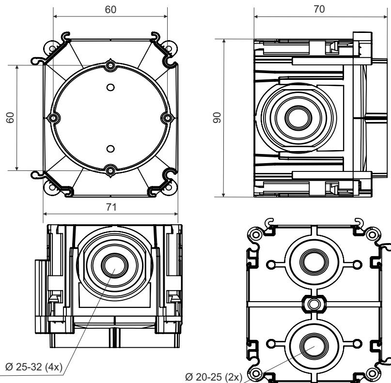
popis výrobku: přístrojová krabice do litých betonů- instalacní hloubka 70 mm
