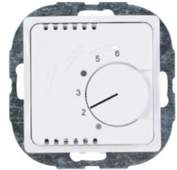
Raumthermostat "Wechsler", kombinierbar mit dem Schalterprogramm PARIS, Temperaturbereich 5°C-30°C, Nachtabsenkung 4 Kelvin, Abschalten des Heizgeräts bei Überschreiten der Solltemperatur und Zuschaltung einer Kühlung, 5(2)AX, 250V~, 1100W, arktisweiß
