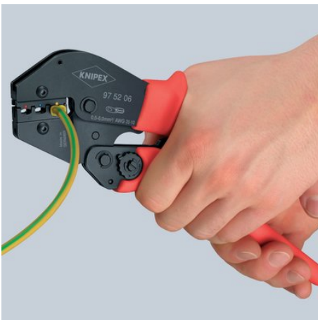
Třetí krok: pokud je zapotřebí větší síla např. u izolovaných spojek 6,00 mm 2 je díky delším rukojetím možné pracovat oběma rukama
