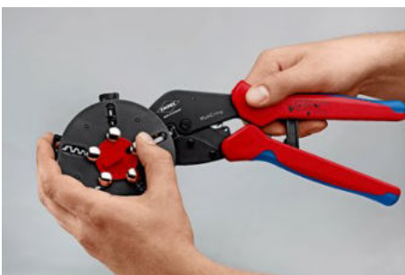
Výměna krimpovacího nástavce: Odaretujte polohu zásobníku, sejměte krimpovací nástavec z kleští.
