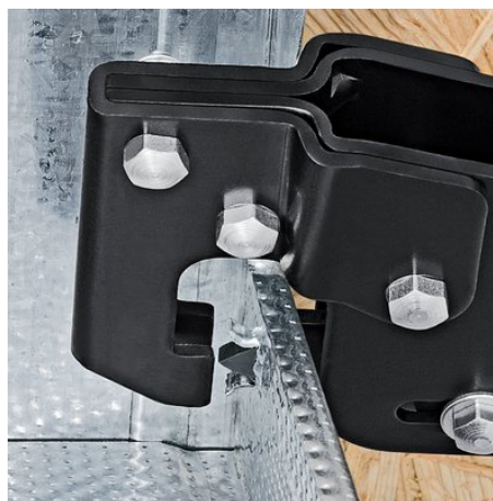
Nasazení kleští na dva spojované profilované plechy
