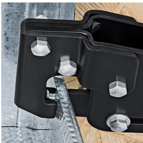
Lisovací nástroj je stlačován profilovanými plechy
