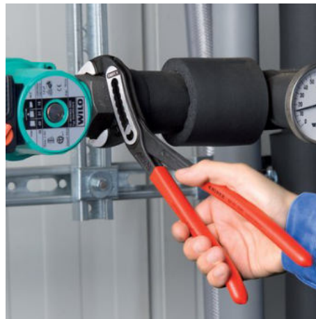
Samosvorné na trubkách a matkách: nehrozí sklouznutí po obrobku; veškerou sílu úchopu lze využít k natočení obrobku; pevný stisk ramen kleští není nutný, díky tomu stačí vynaložení menší síly
