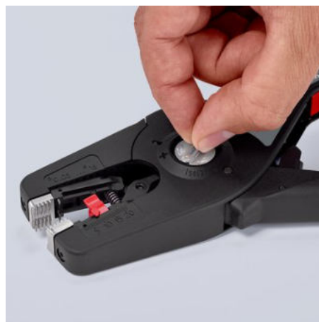
Vyžadují-li to zvláštní okolnosti, například tvrdý nebo měkký izolační materiál, je možné nastavovacím kolečkem s hmatatelnými polohami (s aretací) provést optimální jemné nastavení
