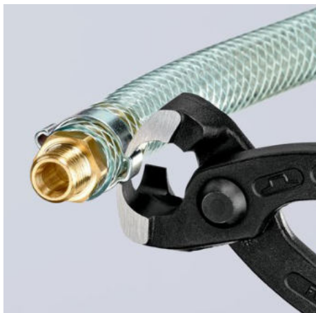
Utěsnění pneumatické hadice na rychlospojce
