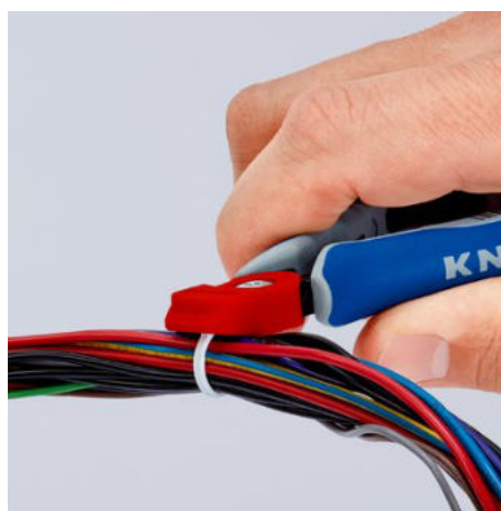
Odstraňte hlavu stahovacího pásku pomocí bočních štípacích kleští na elektroniku...
