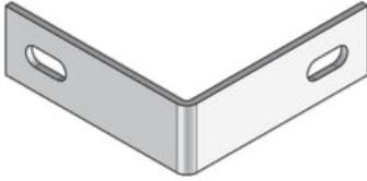
Bei den Bauteilen UBKPRVE handelt es sich um Verbinder für estrichbündige Schwerlastkanäle. Sie sind aus sendzimir-feuerverzinktem Stahlblech gemäß DIN EN 10346, in rechtwinkliger Form mit zwei ovalen Ausschnitten gefertigt. Diese Bauelemente werden dazu verwendet, die Seitenprofile an Stoßstellen mit 90° Bogen miteinander zu verschrauben. Die Verbinder sind in einer Höhe von 30 mm, einer Länge von 90 mm und einer Materialstärke von 3 mm erhältlich.
