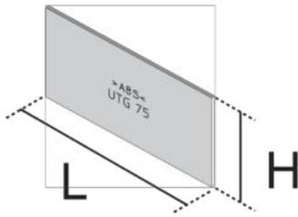
Bei den Bauelementen UTG 75 handelt es sich um Gerätetrennwände aus dem Portfolio der Unterflursysteme. Sie werden an der seitlichen Perforation abgebrochen und von unten in die Gerätebecher eingesetzt. Dort sorgen sie für eine sichere Trennung von unterschiedlichen Stromkreisen und Bestückungen - eine Maßnahme, um Störungen und Fehlfunktionen zu vermeiden. Die Trennwände sind aus hochwertigem Acrylnitril-Butadien-Styrol-Copolymerisat (ABS) in der Farbe Graphitschwarz (RAL 9011) gefertigt.
