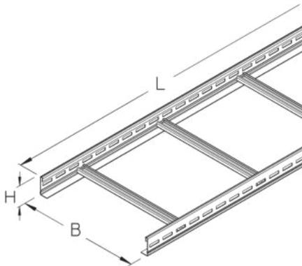
Die gelochten und geschweißten Kabelleitern LGG 60 haben eine Holmhöhe von 60 mm und sind in Bahnbreiten von 200 bis 600 mm sowie in einer Länge von 3000 und 6000 mm erhältlich. Die Sprossen bestehen aus Profilschienen (30 x 15 mm). Verschiedene Materialien und Oberflächen sorgen dafür, dass die Korrosionsanforderungen unterschiedlichster Anwendungsgebiete erfüllt werden.
