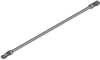
Bei den Bauelementen UVA GB handelt es sich um Erdungsleitungen - ein Hilfsmittel aus dem Sortiment der Einbaueinheiten aus Edelstahl. Die Leitungen sorgen, zum Beispiel als Teil des Erdungslaschensets UEBSEL, für einen zuverlässigen Erdungs- und Potentialausgleich. Diese Zubehörteile müssen auf einer Seite geschraubt und der anderen gesteckt werden. Die UVA GB sind aus hochwertigem Kupfer gefertigt.
