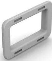
Die Kabelschutzringe KSR 50 aus Polyethylen eignen sich für die Installationskabelrinnen RI 60. Sie können in die Löcher der Kabelrinnen gesetzt werden und dienen dem Schutz der hindurchgeführten Kabel und Leitungen.
