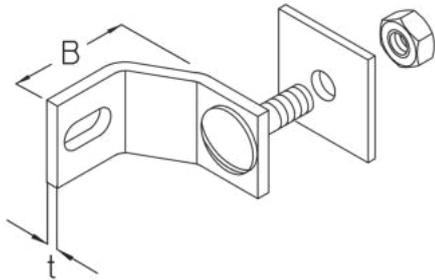
Die Winkellasche BL 7 dient zur Befestigung von Konsolhaltern KHI an der Wand. Zudem lassen sich mithilfe des Winkels die Steigetrassen ST 81 und ST 82 an Decke, Boden und Wand befestigen. Der Winkel wird mit dem Konsolhalter bzw. Steigetrassenholm verschraubt und an die Wand gedübelt. Verschiedene Materialien und Oberflächen sorgen dafür, dass die Korrosionsanforderungen unterschiedlichster Anwendungsgebiete erfüllt werden.
